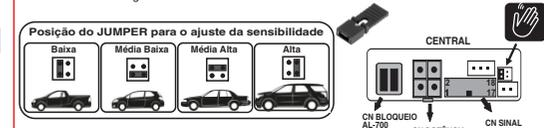
Se não houver jumper no conector, os sensores não funcionarão.
